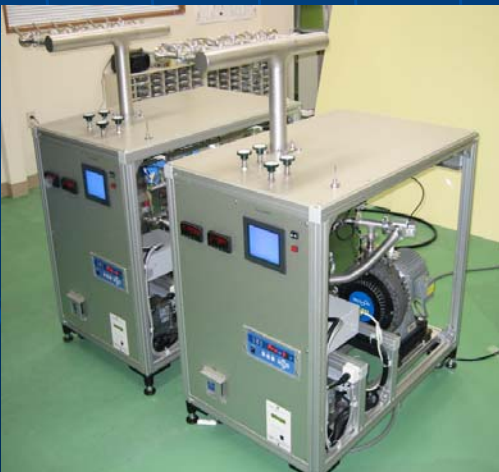
真空排気ユニット
